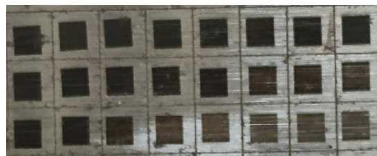
Фиг. 2. Лазерно маркиран образец от стомана S60: 1-ви ред – 0,85 \cdot 10^{10} \text{ W/m}^2 ; 2-ри ред – 1,42 \cdot 10^{10} \text{ W/m}^2 и 3-ти ред – 1,98 \cdot 10^{10} \text{ W/m}^2 .
