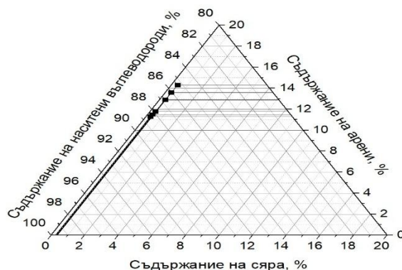
Фиг.6. Разпределение на отделните компоненти в рафинат, получен при екстракция с ДМФА, съотношение изследвана суровина: ДМФА= 1:2
