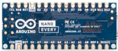
Фиг. 1. Общ изглед на платформата Arduino Nano Every
