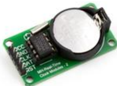
Фиг. 3. Часовник за реално време (RTC Clock) DS1302
